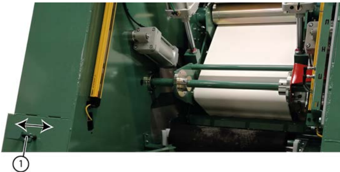
Fig. 30: Mouvement latéral du levier
